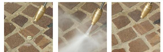
Pistole mit Rotationsdüse zur Entfernung von Kaugummi.
