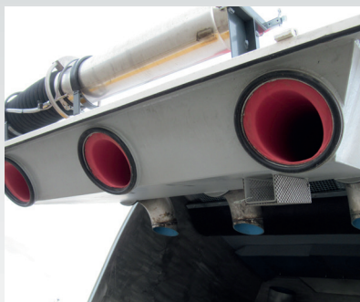
TUBES VULCANISÉS INTÉGRÉS À LA PORTE ARRIÈRE
