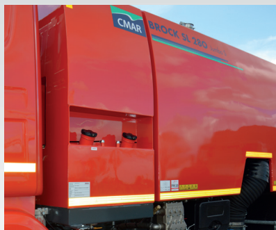
CUVE À EAU DERRIÈRE LA CABINE
